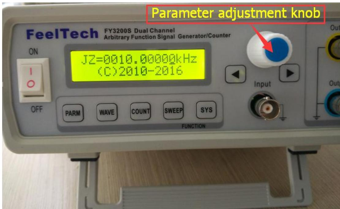
3、用示波器测量CH1通道输出的频率，如果测量到的频率低于10.00000KHz，就逆时针旋转参数调节旋钮减小对应数值，当测量到的CH1通道输出频率为10KHz时，向下按动参数调节旋钮，然后断电，再开机，频率校准完成。
